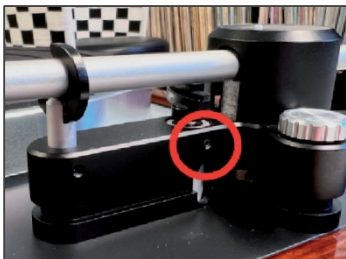
Obr. 15 Nastavení výšky výtahu.
