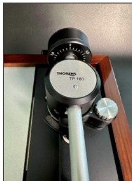
Obr. 8 Ložiskový blok, instalované protizávaží se stupnicí síly ložiska a nastavení proti prokluzu.
