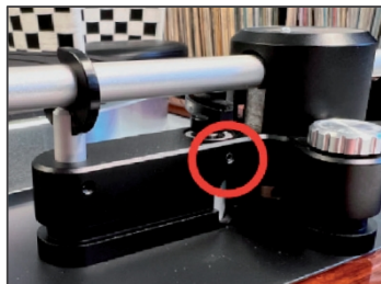
Obr. 15 Nastavení výšky výtahu
